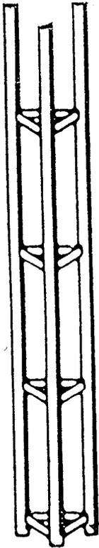
Die RUX-Dreieckstützen dienen zur Aufnahme von hohen Lasten im Fassaden- und Lehrgerüstbau.
