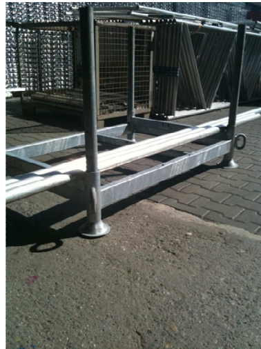
Palette mit aufgesteckten Rungenrohren und Material
