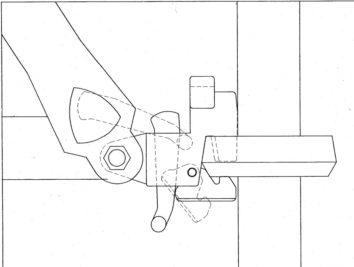
Der Anschluß-Kopf der RUX-VARIANT-Diagonale wurde entsprechend dem neuen VARIANT-Prinzip geändert.
