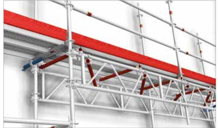
Bild 54: Beispiel 2 einer Gitterträger-Überbrückung mit Verankerung und aussteifendem Obergurt-Verband
