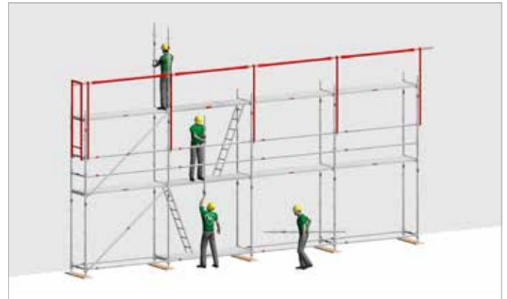
Bild 3: Beispiel für den Vertikaltransport von Gerüstbauteilen von Hand
