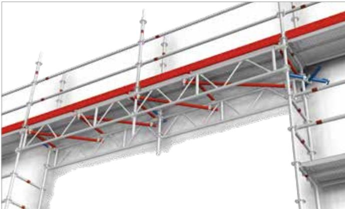
Bild 53: Beispiel 1 einer Gitterträger-Überbrückung mit Verankerung und aussteifendem Obergurt-Verband
