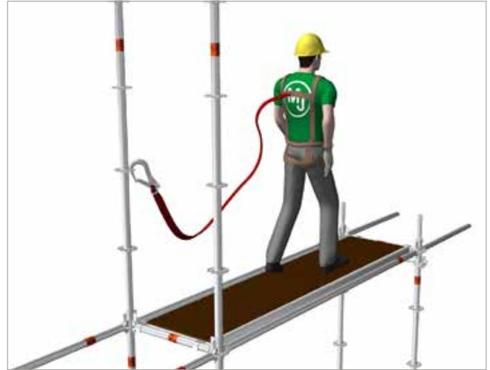
Bild 76: Anschlag an einem in der Belagebene durchgehenden, nicht gestoßenen Stiel, maximal 1,0 m über der Belagebene
