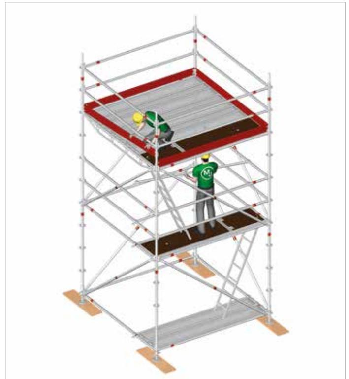
Bild 62: Vollständig montierte Zwischenebene ohne Gerüstdielen und Ausbau der Arbeitsebene inklusive Seitenschutz durch Bordbretter sowie Riegeln
