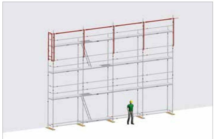
Bild 36: Montage der nächsten Gerüstlage im Schutze der MSG
