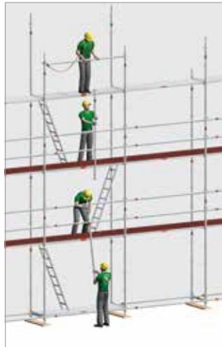
Bild 39: Beispiel 2 für den Aufbau des Gerüsts mit PSAGa
