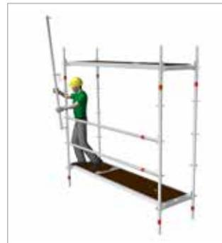
Bild 67: Montage des ersten Gerüstpfostens
