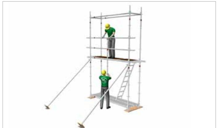
Bild 2: Beispiel für eine vorübergehende Kippsicherung der ersten Gerüstlage bei Montage eines Fassadengerüsts
