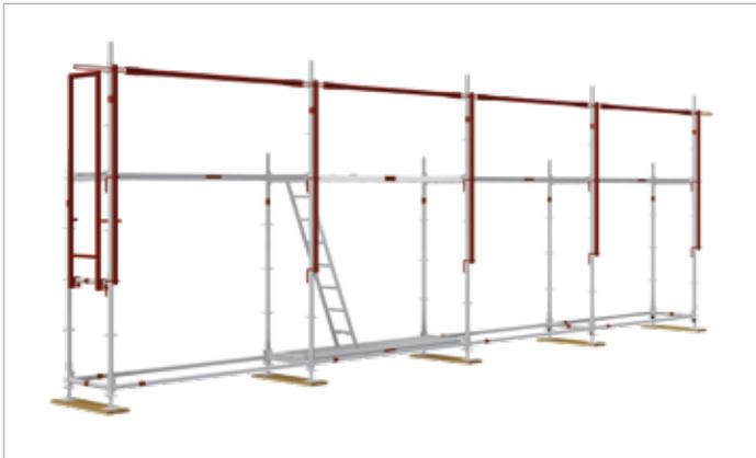
Bild 35: Gerüstlage mit umlaufendem Montagesicherheitsgeländer (MSG)
