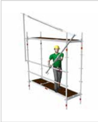
Bild 69: Montage des zweiten MSG-Pfostens mit eingehängtem Geländerholm (unten)
