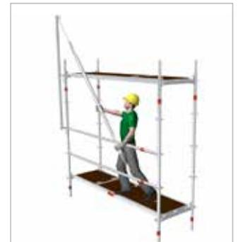
Bild 68: Einhängen des MSG-Geländerholmes
