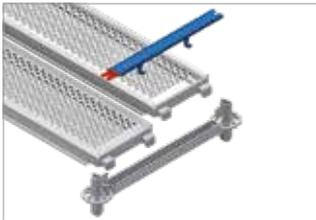
Bild 24: Beläge in das U-Profil einlegen und die Zunge der Absicherung hochklappen
