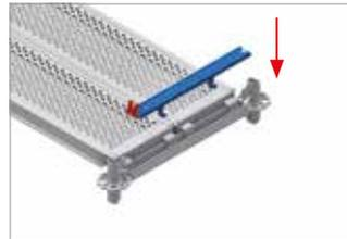
Bild 25: Abhubsicherung in das U-Profil einlegen und die Sicherungshaken in die Aussparung des U-Profils einführen
