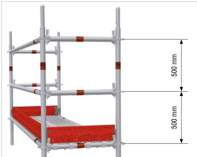
Bild 44: Vollständiger Seitenschutz (dreiteilig)
