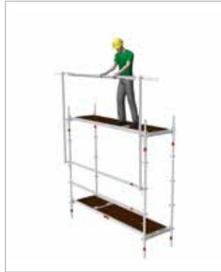
Bild 70: An der Gerüstlängsseite fertig montiertes MSG (rechts)
