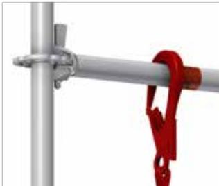
Bild 74: Anschlag an einem O-Riegel an beliebiger Stelle, bei in der Belagebene nicht gestoßenen Stiel, sowohl in 1,0 m als auch in 2,0 m Höhe über der Belagebene
