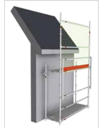
Bild 52: Schutzwand - Ausbildung mit Verstärkungsrohren am Stoß in Belaghöhe
