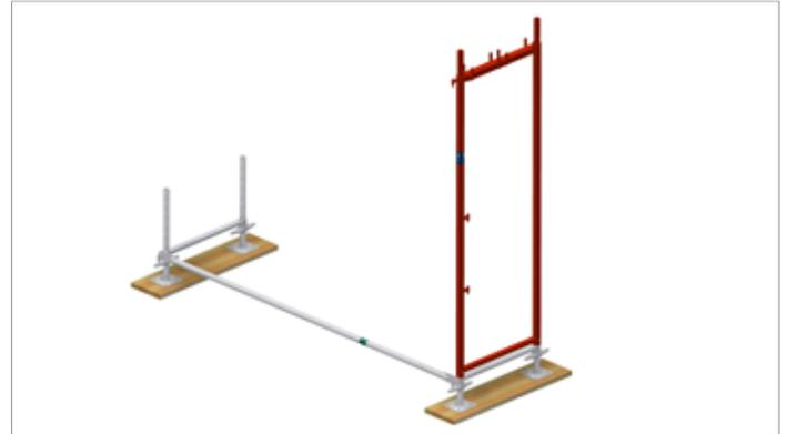
Bild 12: Aufstecken des ersten Vertikalrahmens auf die Spindeln
