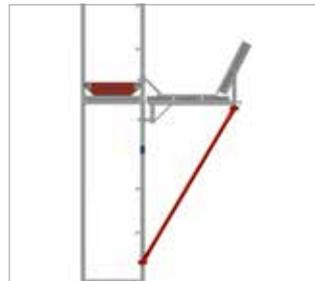
Bild 64: Dreibohlige Konsole 1,0 m mit Konsoldiagonalen
