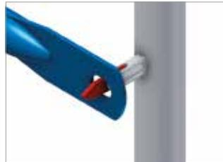
Bild 19: Aufschieben des Geländerholms auf den Kippstift
