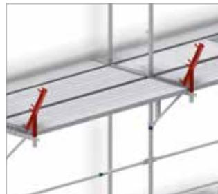
Bild 66: Montage der Schutzdachaufsätze
