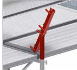
Bild 67: Montage der Schutzdachaufsätze (Detail)
