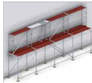
Bild 79: Gerüstabschnitt mit Durchgangsrahmen und Verstrebungen sowie Verankerungen in Höhe  $H = 4,0\text{ m}$ , Montage der zweiten Lage
