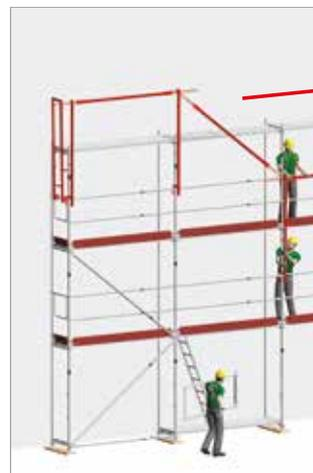
Bild 37: Hochsetzen des Montagesicherheitsgeländers (MSG)
