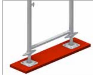
Bild 4: Lastverteilernder Unterbau mit Gerüstbohlen
