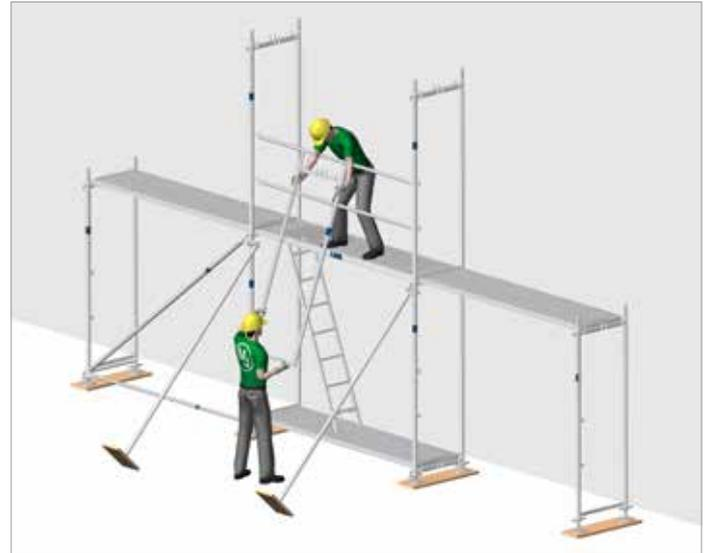
Bild 2: Beispiel für eine vorübergehende Kippstützung bei Montage der zweiten Gerüstlage
