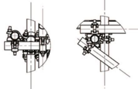
Wenn erforderlich Rohrstoß mit Rohrverbinder und Zugkupplung
