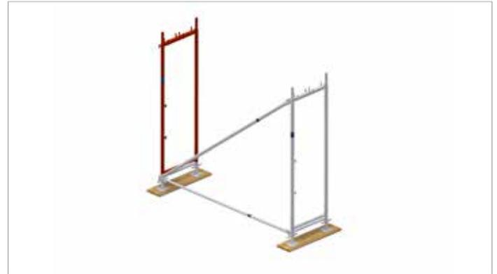
Bild 16: Aufbau des ersten Gerüstfeldes, zweiter Vertikalrahmen
