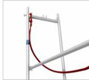
Bild 95: Anschlag am Ständer über dem oberen Querriegel
