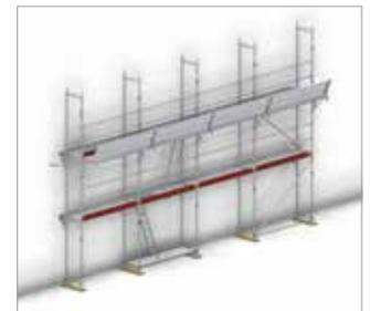
Bild 72: Fertige Montage des Schutzdaches
