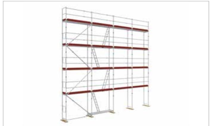
Bild 49: Weitere Gerüstlagen mit innenliegendem Leitengang
