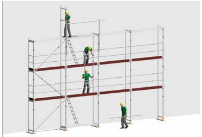
Bild 40: Montage des Aufstiegsfeldes im Schutze des MSG
