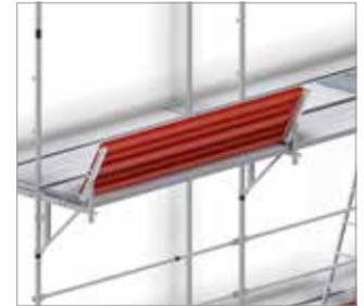
Bild 68: Systembeläge auf Schutzdachaufsatz
