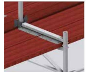
Bild 80: Belagsicherung auf Durchgangsrahmen (Detail)
