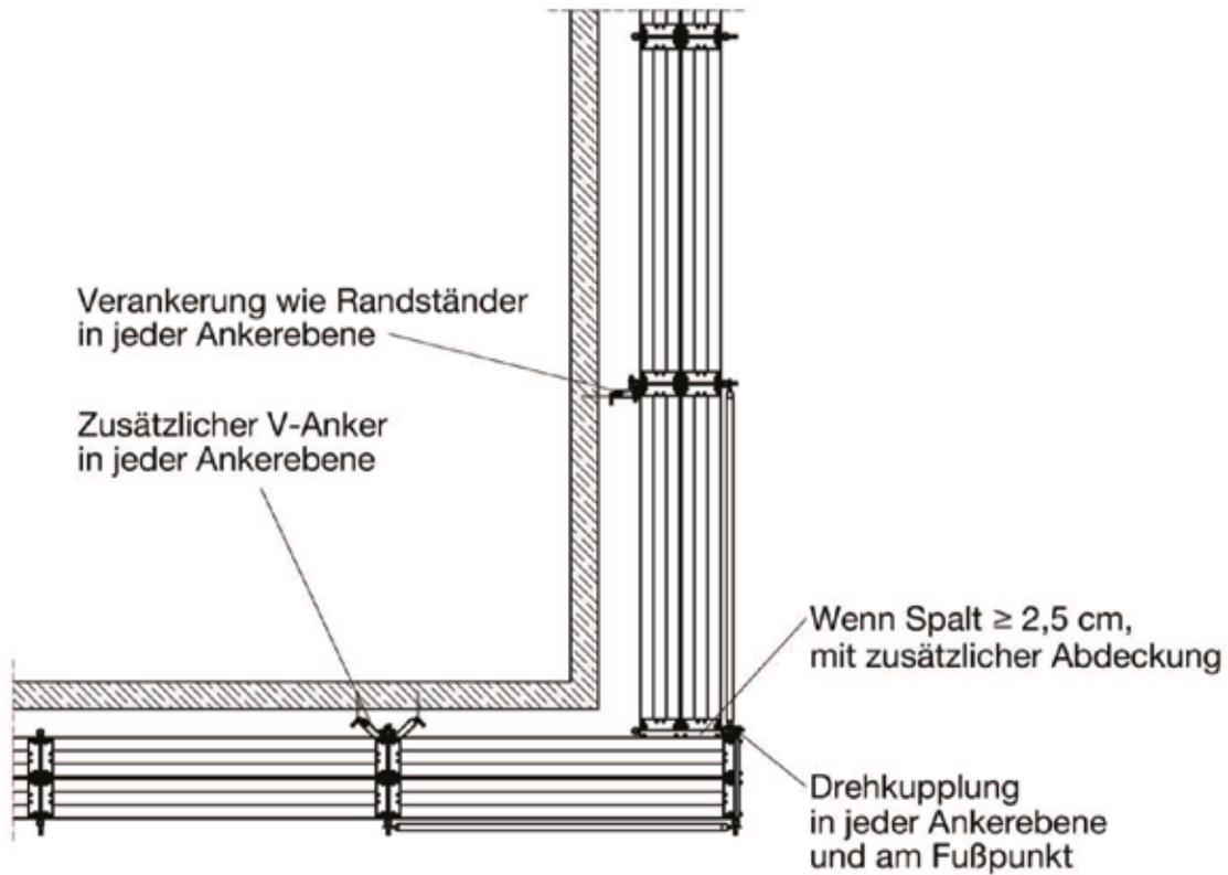
Ausführungsdetails: versetzter Gerüsthalter (max. 30,0 cm versetzt in einer Gerüstlage)
