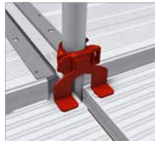
Bild 58: Sicherung der Böden mit Belagsicherung
