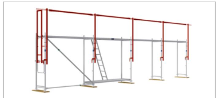
Bild 33: Erste Gerüstlage mit umlaufendem Montagesicherheitsgeländer (MSG)
