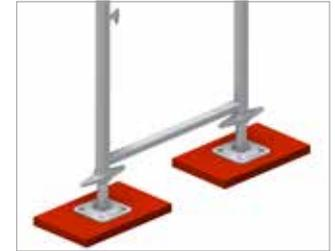
Bild 5: Lastverteilernder Unterbau mit Bohlenstücken unter jeder Fußplatte
