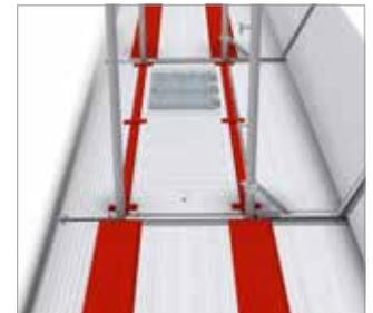
Bild 70: Spaltabdeckung zwischen Haupt- und Schutzdachbelag sowie zwischen Haupt- und Konsolenbelag
