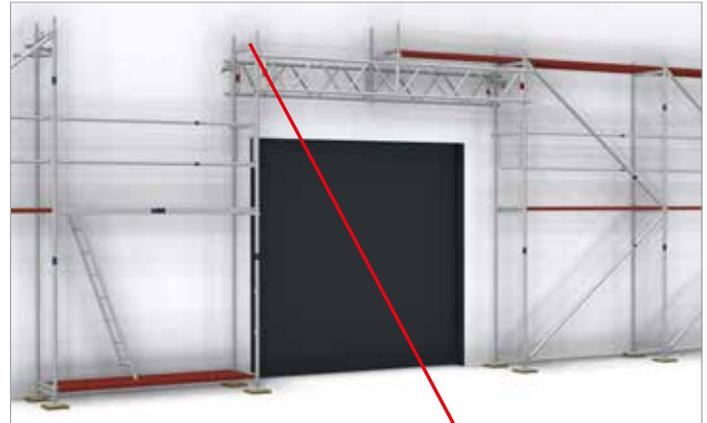
Bild 81: Montage eines Gerüstabschnittes mit Gitterträgerüberbrückung
