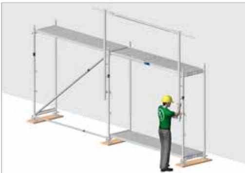
Bild 91: Montage des zweiten MSG-Pfostens
