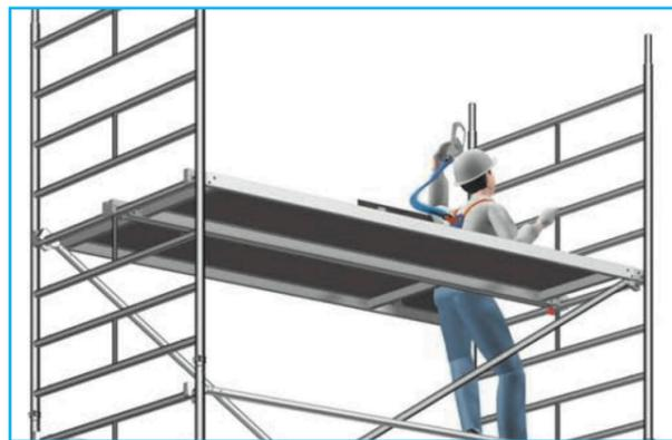
Anschlagen der PSA während des Aufstiegs in die ungesicherte Lage
