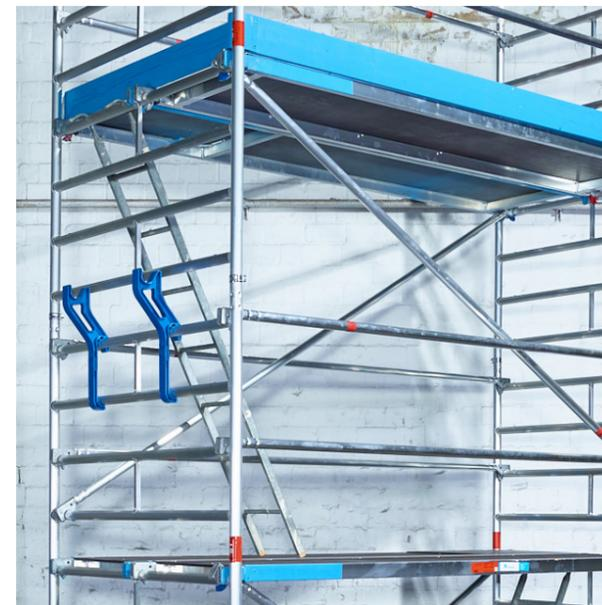
Für einen komfortableren Aufstieg können die Fahrgerüste problemlos mit der Gerüst-Etagenleiter 32 ausgestattet werden. Die Leiter wird einfach auf der Seite der Dachstiegleiter in die 8. Sprosse der Standleiter (Bodenhöhe) eingehängt und auf dem darunterliegenden Boden aufgestellt.
