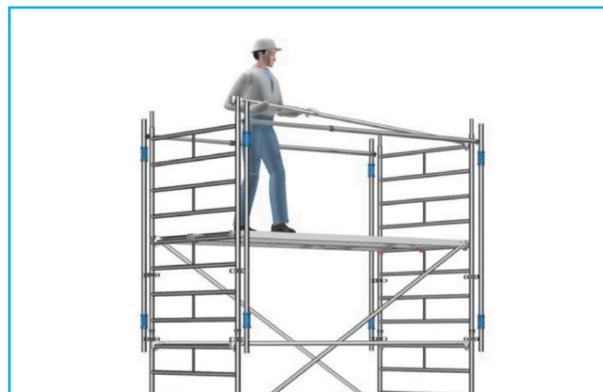
Sichere Montage der Rückenlehnen mit MSG
