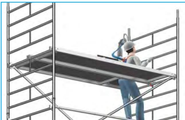
Anschlagen der PSA während des Aufstiegs in die ungesicherte Lage
