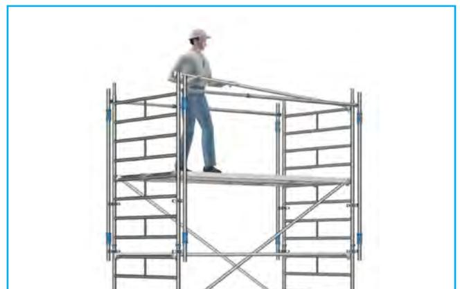
Sichere Montage der Rückenlehnen mit MSG
