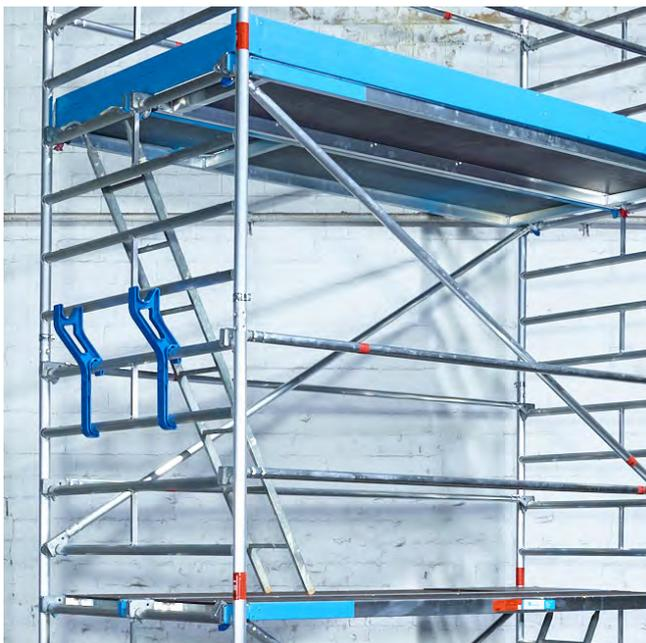
Für einen komfortableren Aufstieg können die Fahrgerüste problemlos mit der Gerüst-Etagenleiter 32 ausgestattet werden. Die Leiter wird einfach auf der Seite der Duchstieglappe in die 8. Sprosse der Standleiter (Bodenhöhe) eingehängt und auf dem darunterliegenden Boden aufgestellt.
